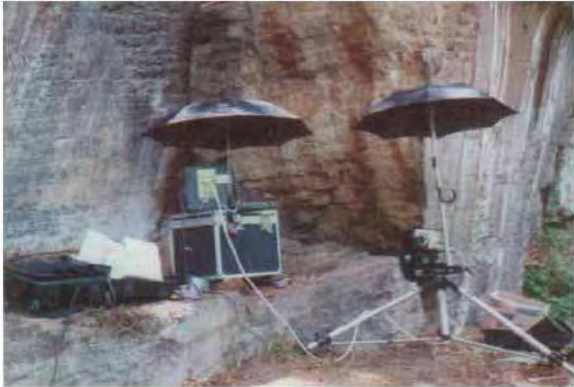
Figura 1a. Típica disposición del equipo para imágenes multiespectrales en Golondrinas.
