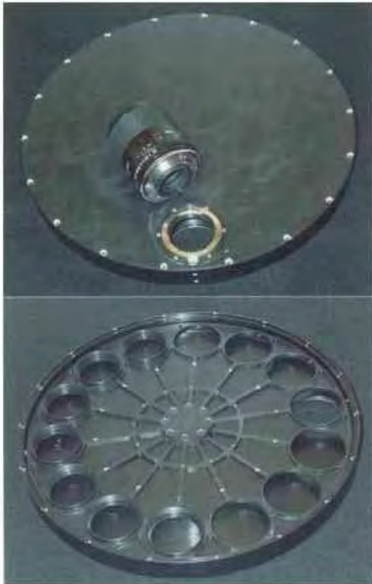
Figura 5a. Rueda de filtros y lentes (arriba), e interior de la rueda de filtros (abajo).
