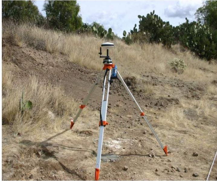
Foto 7. Medición de las coordenadas con GPS global.
