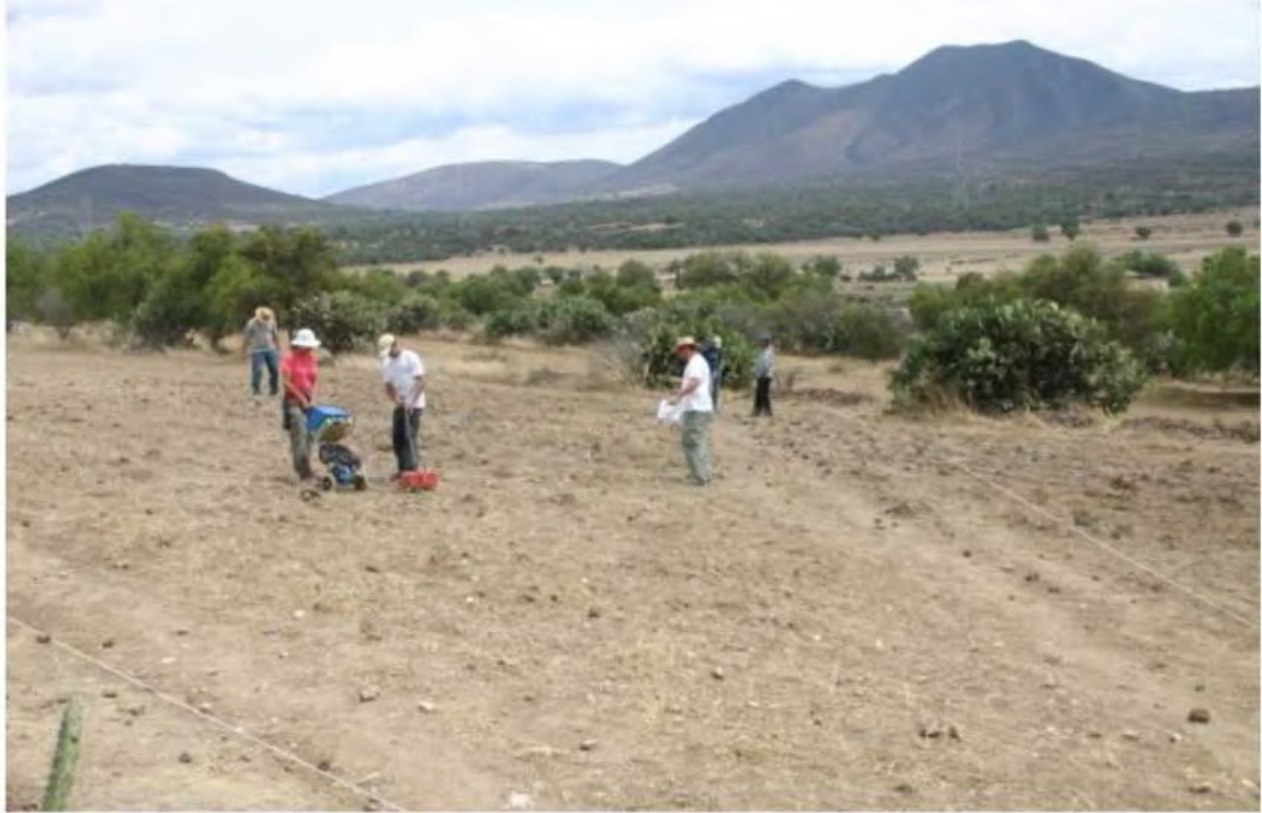
Foto 9. Prospección con Radar de penetración.
