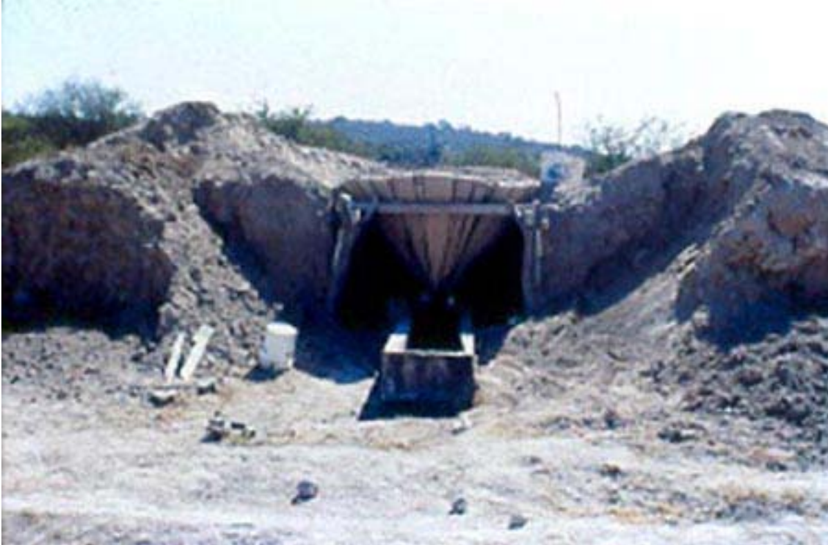
Figura 3. Estiladera, elemento de madera que se usa para extraer salmuera de la tierra por medio de la lixiviación.
